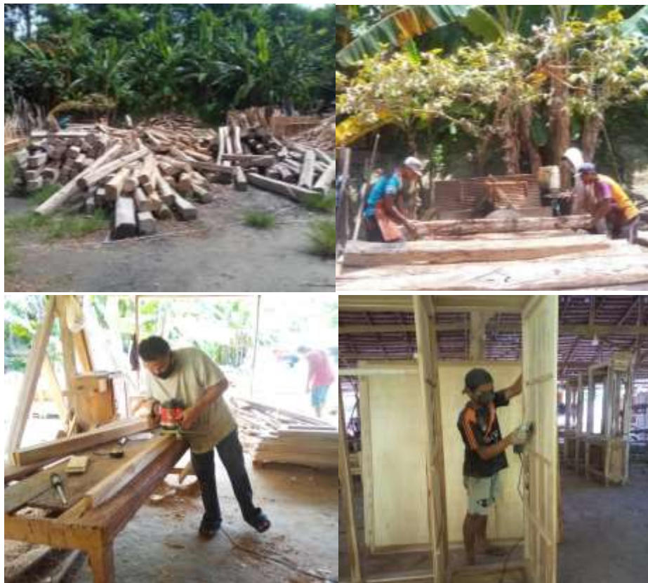
Gambar 3. Proses Produksi Kayu menjadi Mebel
