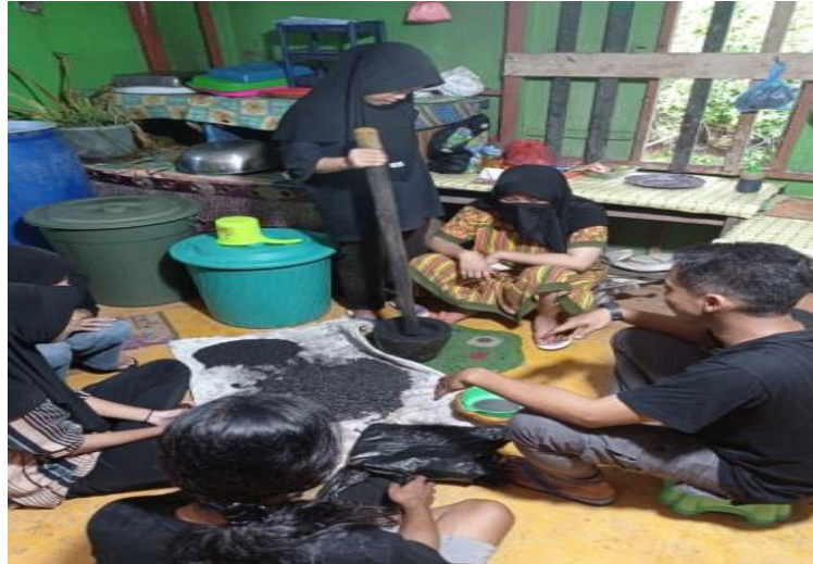
Gambar 2. Proses Penghalusan Arang Cangkang Kemiri
